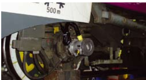
Messradsatz zur Messung der Rad-Schienen-Kräfte während den lauftechnischen Zulassungsfahrten
