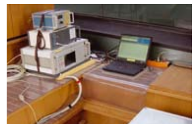
Gegen Seegang und Vibrationen gesicherte Messausrüstung an Bord der Yacht
