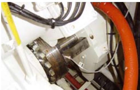
Sensor zur Messung der Drehzahl des Dieselmotors
