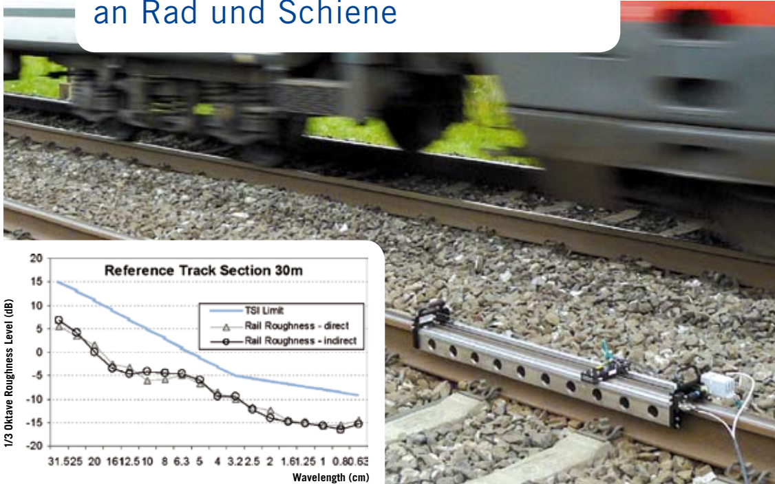
Rauheitsmessung auf Schienen
