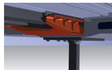
Stahladapter (rot) zur Verstärkung des Schemelträgers, CAD-Modell
