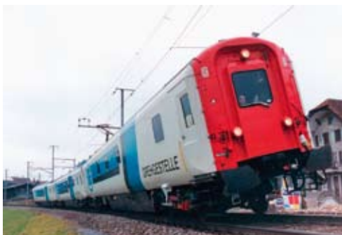
Versuchsträger NEITEC, bestehend aus drei ehemaligen Mark-III-Wagen von British Rail
