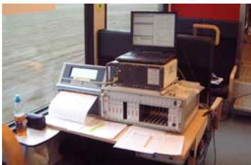
Der Messaufbau für Speicherung und Online-Grenzwertüberwachung
