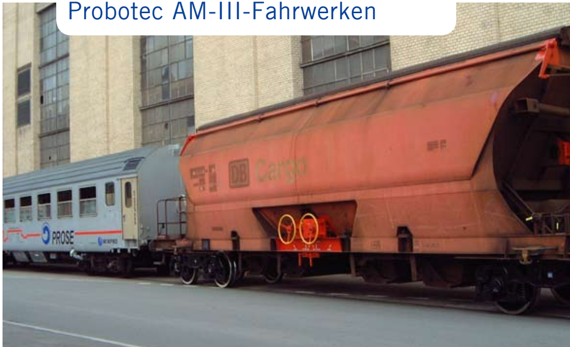
Die Messkomposition aus Tanoos-Güterwagen mit Probotec AM-III-Fahrwerken und dem PROSE-Messwagen beim Verlassen des Werksgeländes der ehemaligen Schweizerischen Lokomotiv- und Maschinenfabrik SLM
