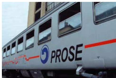
Der Messwagen der PROSE AG basiert auf einem RIC-Reisezugwagen.
