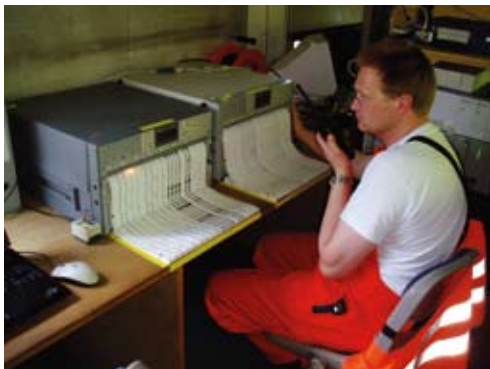
Überwachung der Messsignale der Messradsätze und weiterer Sensoren am Güterwagen im Messabteil des PROSE-Messwagens
