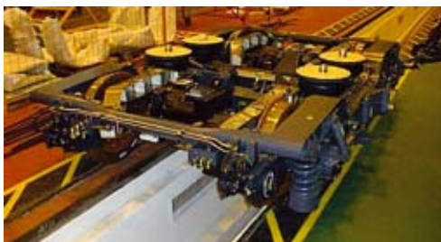
Jakobs motor bogie for the CP 2000
