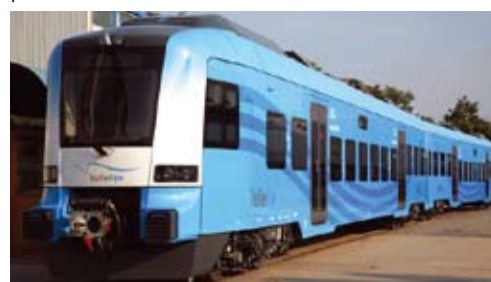
Treno automotore piano ribassato PROTOS® per la Connexion Holland della FTD Fahrzeugtechnik Dessau
