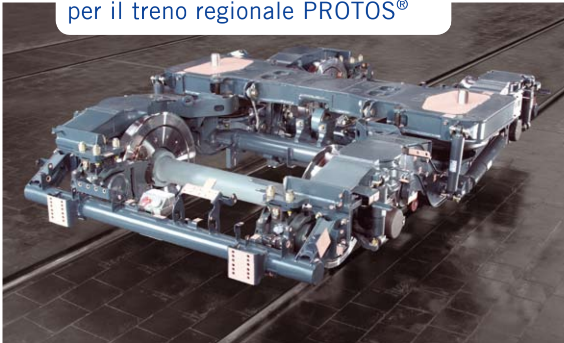
Il carrello portante PROTOS® in occasione del Rollout del treno regionale PROTOS®
