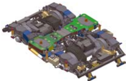
Spaccato in 3D del carrello motore portante PROTOS®
