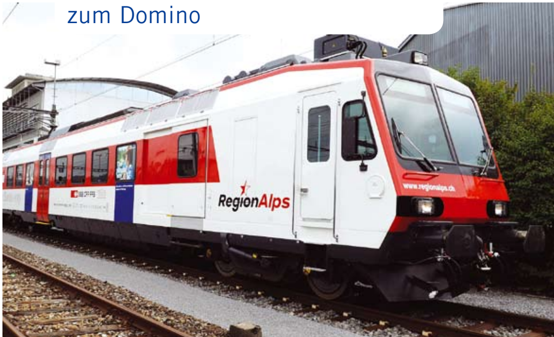
Domino Triebwagen in neuem Farbleid für die SBB-Tochterfirma Region Alps. Markanter Blickfang sind die auf dem Dach befestigten Klimageräte. Diese erhöhen einerseits den Komfort, die Integration der Geräte war andererseits eine technischer Herausforderung.
