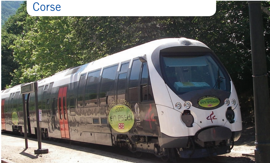
Rame automotrice diesel à écartement d'1m AMG 800 lors des tests de type sur le réseau ferroviaire corse
