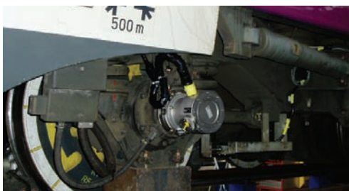
Essieu de test pour les mesures de forces roue-rail pendant les essais de comportement dynamique en vue de l'homologation
