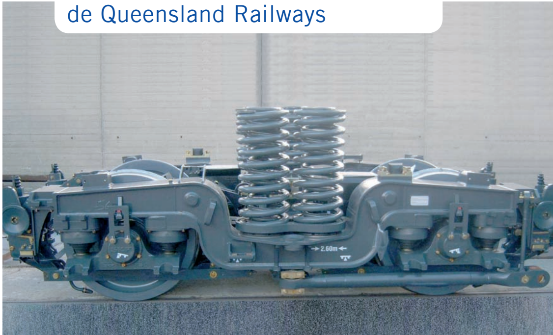
Bogie moteur pour voies étroites (1067 mm) avec transmission latérale pour la locomotive à 6 essieux de type QR 3800
