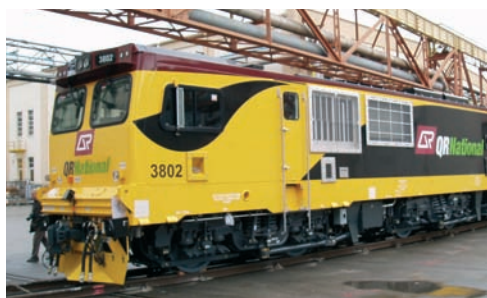
Locomotive électrique à 6 essieux de la série QR 3800 (Type Bo'Bo'Bo')
