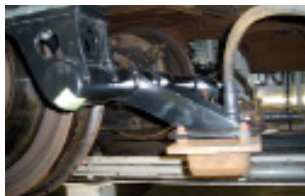
Concept, design, test et production de 46 nouveaux supports d'antennes sur les bogies de MTRC Lantau Island Airport
