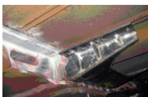
Analyse des dégâts et réparation de châssis de wagons en aluminium pour le Metro de Medellin en Colombie
