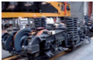
Développement et design de bogies pour la locomotive de type 3800 Bo'Bo'Bo' de Queensland Railways en Australie
