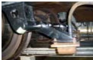
Konzeption, Konstruktion, Tests und Fertigung von 46 neuen Antennenträgern an den Drehgestellen von MTRC Lantau Island Airport.
