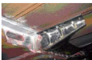
Schadenanalyse und Reparaturlösung für Aluminium-Wagenkasten der Metro de Medellín, Kolumbien.
