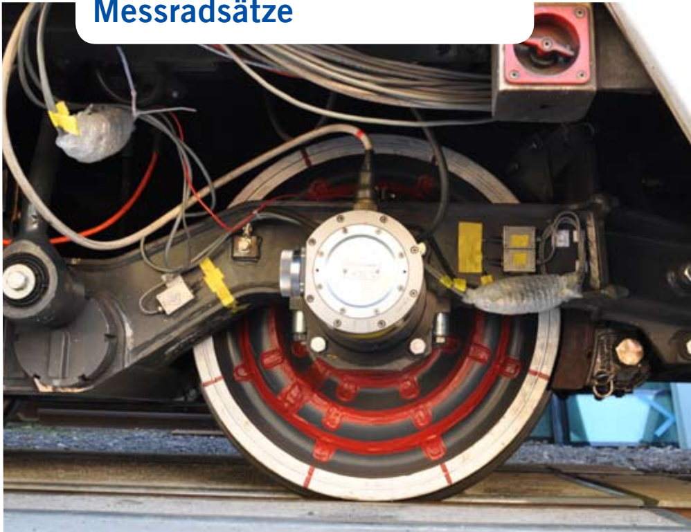
PROSE Mess-Losradpaar PRO03A/B eingebaut in das PROSE-Drehgestell MOB EV09 bei Erprobungsfahrten zwischen Montreux und Zweisimmen
