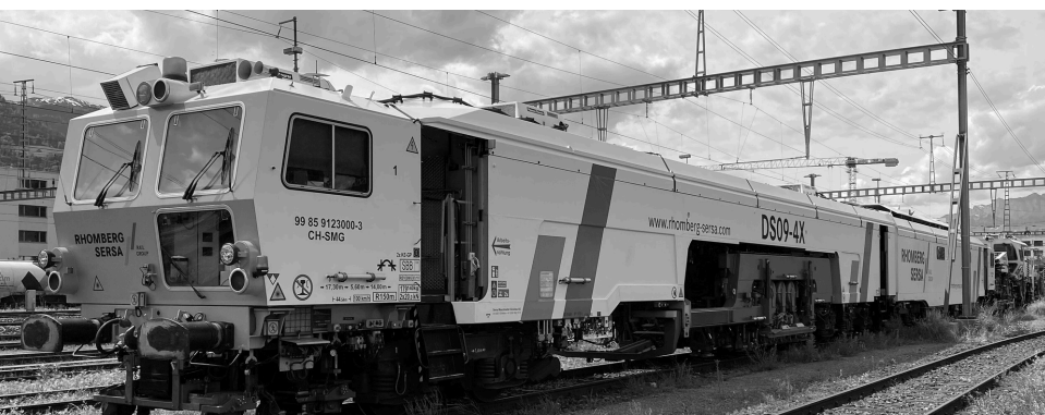
Streckenstopfmaschine DS09-4X und Planiermaschine USP-1 (im Hintergrund), Plasser&Theurer, betrieben durch Rhomberg Sersa (Foto Rhomberg Sersa)
